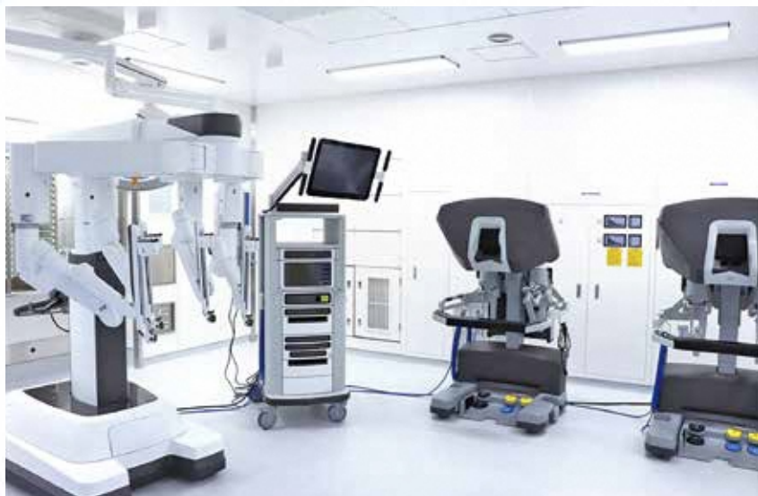
■左から ペイシェントカート、ビジョンカート、サージョンコンソール
